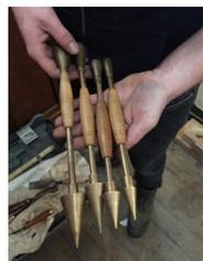
**Techniques d'harmonisation et d'accord :** le Facteur d'orgue modifie le son en se servant d'outils très spécifiques ; la « cloche » pour réduire l'ouverture du pied du tuyau, et réduire d'autant le débit du vent ou un « cône à pied » pour l'augmenter ; un « marteau d'harmonie » ou une « spatule » pour rectifier les lèvres du tuyau
